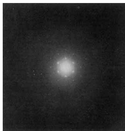
Abb. 3. Elektronenbeugungsbild des diskotischen Polymers 1a, D_{ho} -Phase, Blick entlang der Kolumnenachse.
